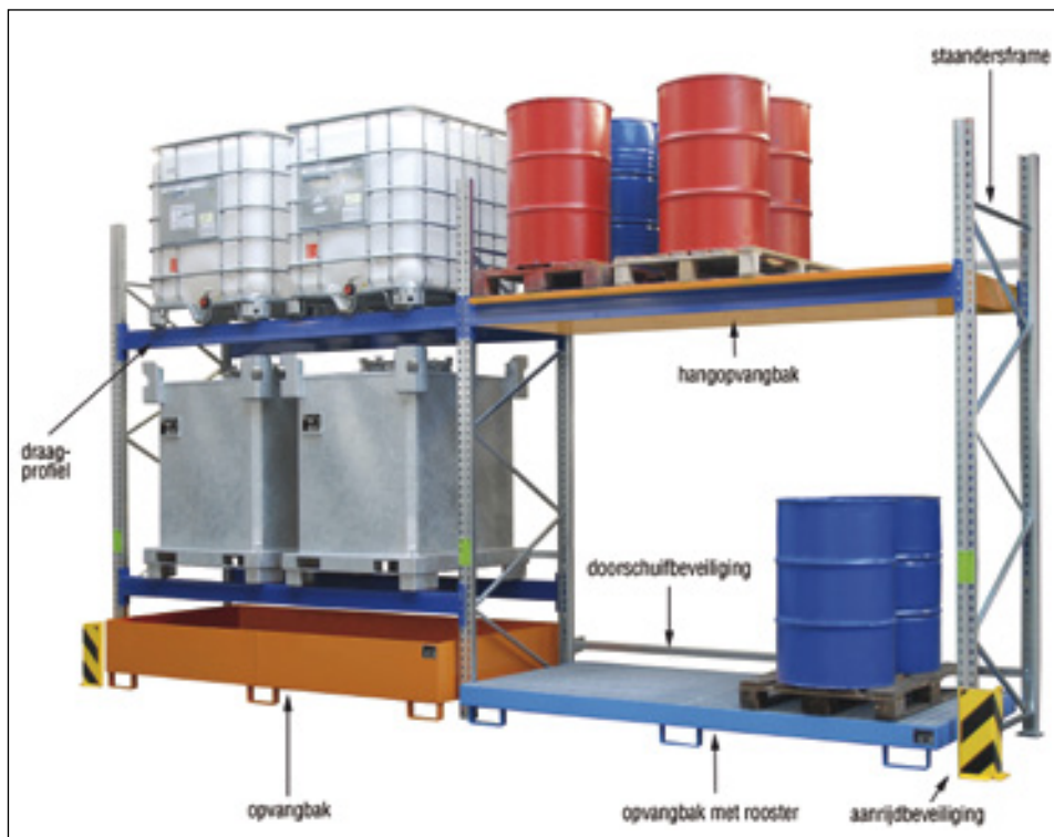
PR set 1 voor max. 12 x 200 liter vaten bestaande uit: 2 x staanderframe type PR-S 2000 2 x draagprofiel type PR-T 2700-1 2 x doorschuifbeveiliging type PR-D 2700 1 x opvangbak type RW-GR 2700-1 optie: aanrijdbeveiliging (per stuk)
