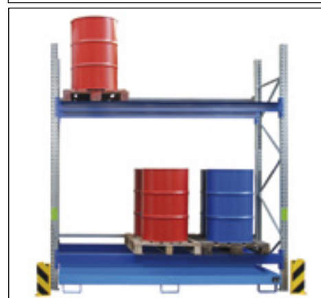
PR set 2 voor max. 12 x 200 liter vaten bestaande uit: 2 x staanderframe type PR-S 3000 4 x draagprofiel type PR-T 2700-1 2 x doorschuifbeveiliging type PR-D 2700 1 x opvangbak type RW 2700-1 optie: aanrijdbeveiliging (per stuk)
