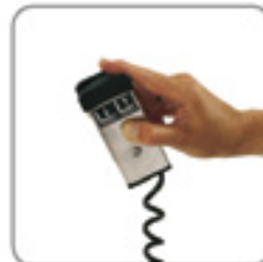
De draaifunctie van de elektrische vatenkantelaar wordt door een afstandsbediening bediend.
